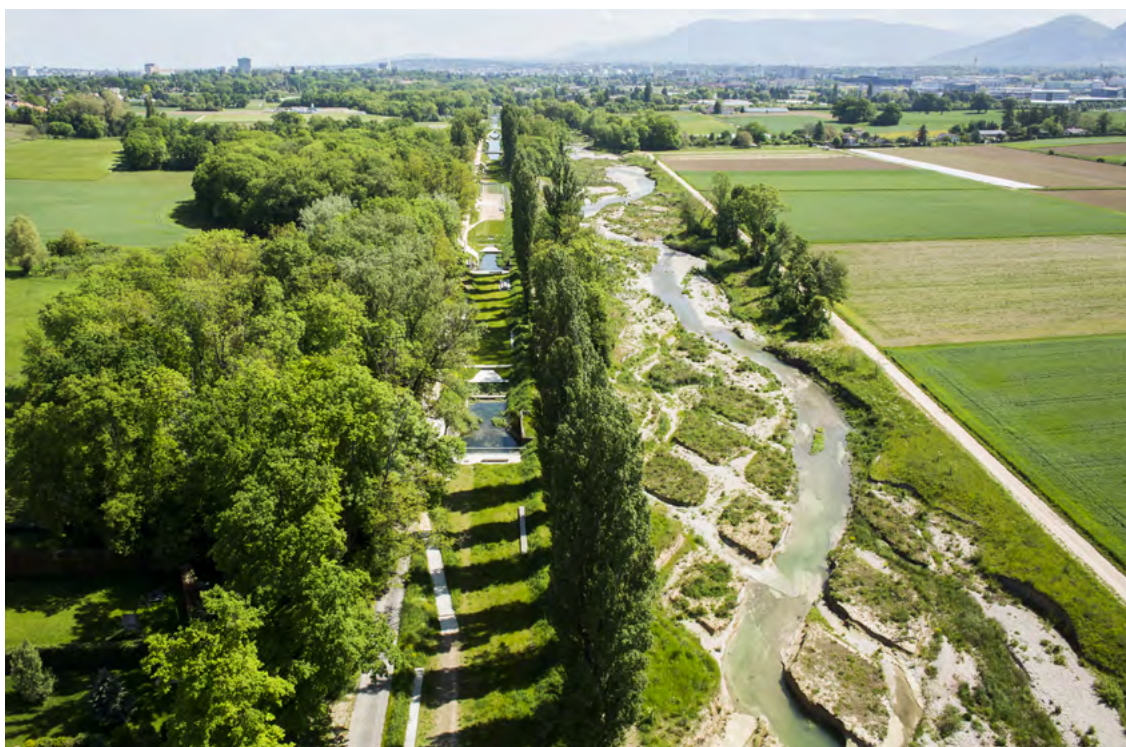
Figura 2: (©Fabio Chironi): Os dois cursos d'água do Rio Aire justapostos, perto de Genebra: o canal retido à esquerda com uma série de jardins lineares, o novo leito do rio à direita com losangos parcialmente erodidos.
