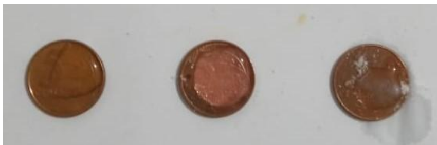
Figura 3 - Adição de 1. vinagre (ácido acético); 2. solução de vinagre (ácido acético) e sal (cloreto de sódio) e 3. solução de água e sal (cloreto de sódio) nas faces de uma moeda de cinco centavo. Fonte: Dados da pesquisa.
