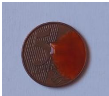
Figura 1 - Adição de molho de pimenta industrializado na metade da face de uma moeda de 5 centavos.
